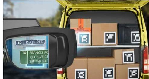
**Abbildung 57: Anwendungsbeispiel für Eye Tracking: Auswahl eines 2D-Barcodes unter vielen in Kontext der Paketlogistik ; Blick durch das Smart-Glass-Display [86]**
