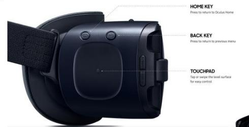
**Abbildung 19: Bedienelemente an der Samsung GearVR: 2D-Touchpad, Home Key, Bak Key, Hoch- und Runter-Taste [71]**
