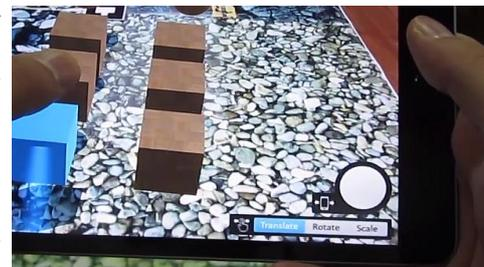
**Abbildung 42: Über das HUD-Menü unten rechts wird ausgewählt, ob selektiert, verschoben, rotiert oder skaliert werden soll. Der weiße Kreis mit schwarzem Ring entspricht der Feststelltaste [78]**
