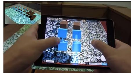
**Abbildung 45: Größenskalierung selektierter Objekte durch Ziehen mit 2 Daumen [78]**
