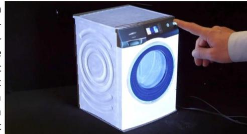
**Abbildung 9: 3D-Druck mit Aufprojektion und eingebauten Touch-Sensoren**
