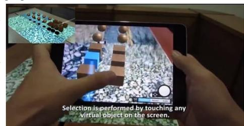
**Abbildung 43: Selektion von Objekten durch Antippen auf dem Touch Screen. Blau sind die bereits selektierten Objekte, die anschließend gruppiert werden [78]**
