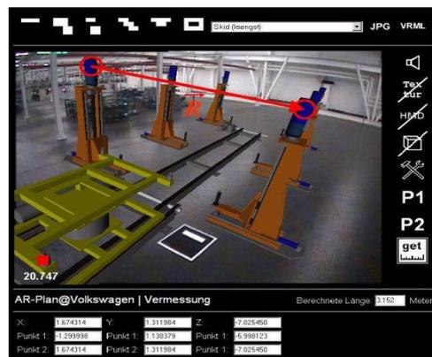
**Abbildung 38: HUD des VW-Fabrikplanungsassistenten mit Eingabemöglichkeiten für die exakte Positionierung und Vermessung [35][36][37]**
