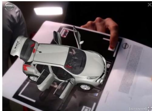
**Abbildung 53: Ein einfaches System zur Konfiguration eines Nissan-PKW: Der Nutzer legt seinen Finger auf die Stelle im Katalog. Die Kamera erfasst dieses, Der Rechner zeigt die Szene auf dem Bildschirm und ändert das Fahrzeug [82]**
